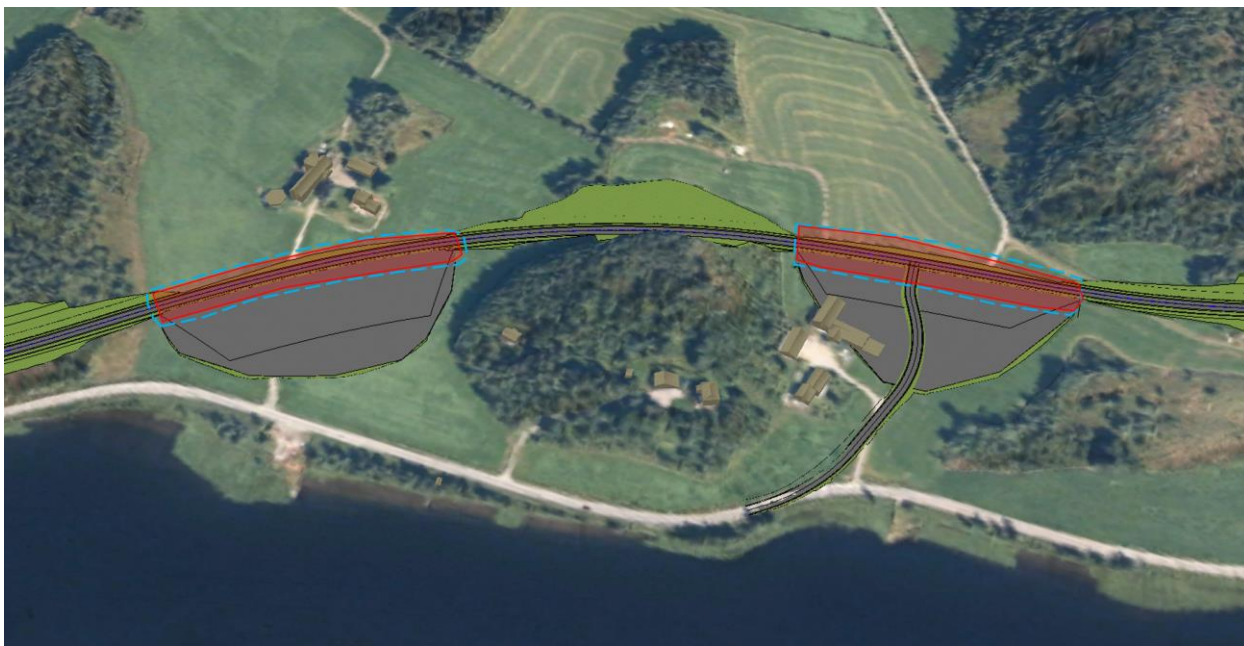
Figur 4.31 Sikringstiltak mellom profil 4200 og 4900, gråskravur = motfylling, blåstiplelinje = vertikaldren og rødskravur = KS-peler, nord er oppover i figuren
