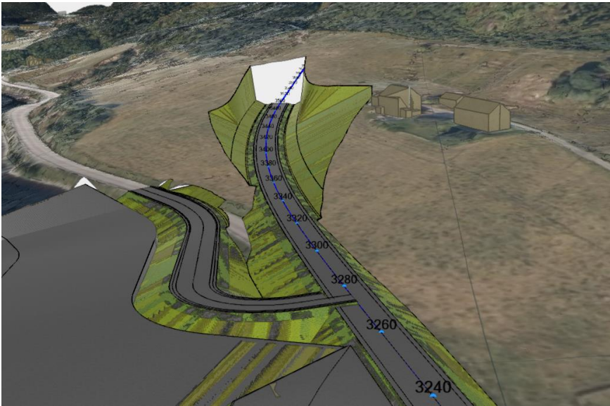
Figur 4.14 utklipp fra modell for østlig påhugg (profil 3500) østlig tunnel. Det er modellert løsmasseskjæring for å vise mulig skråningsutslag mot bebyggelse. Omfanget kan bli større
