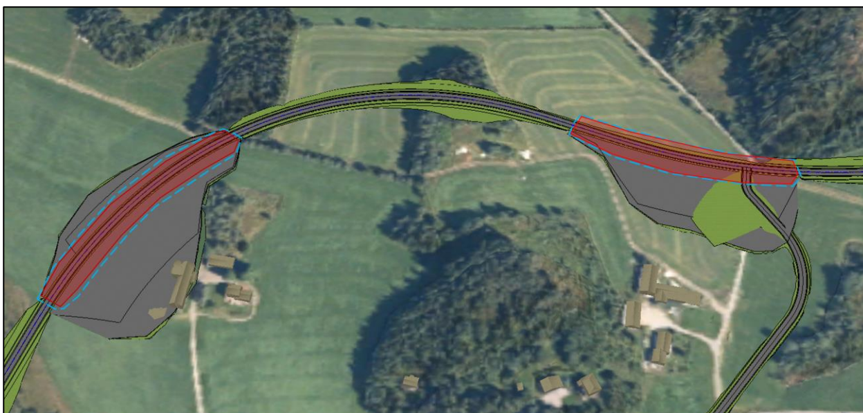
Figur 4.38 Sikringstiltak mellom profil 4200 og 5000, grå skravur = motfylling, blå stippet linje = vertikaldren og rød skravur = KS-peler. Nord er oppover i figuren
