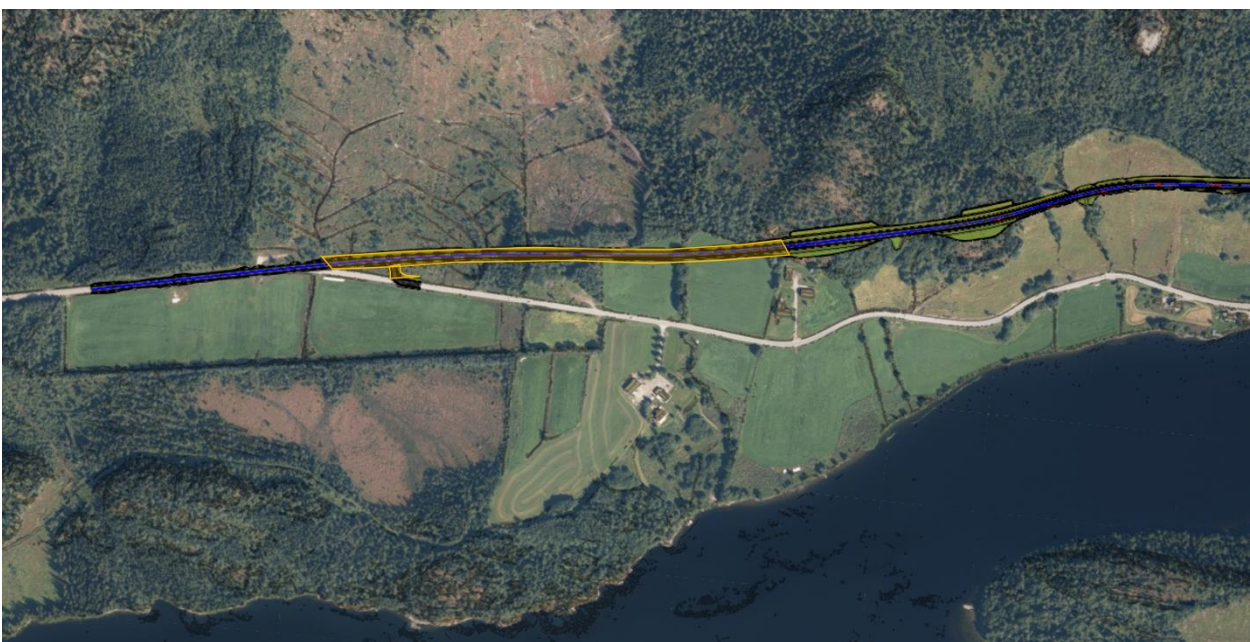
Figur 4.22: Sikringstiltak mellom profil 6750 og 7320, lette masser er markert med gul skravur
